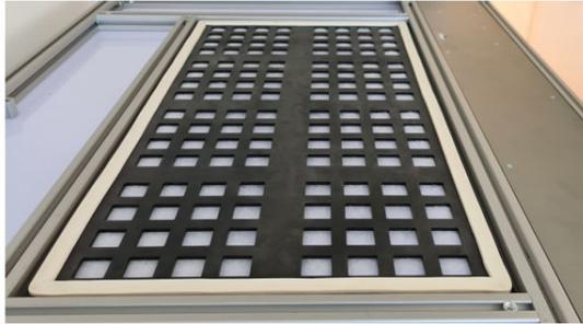
5. Setzen Sie den Luftkanaladapter ein und achten Sie darauf, dass er an allen Seiten richtig befestigt ist.
