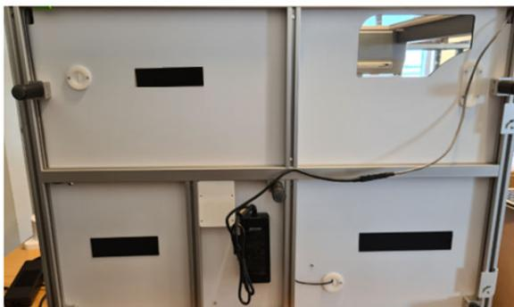
10. Installieren Sie die Stromversorgungseinheit des Andrew+ (Position 1) und führen Sie das Kabel durch die Anschlussöffnung für das Andrew+ Stromkabel (Position 5).
