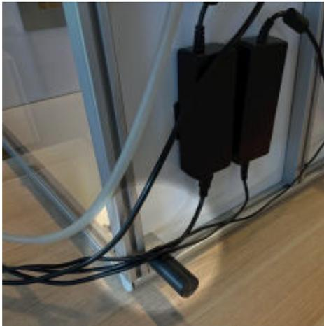
**Hinweis:** Zur einfacheren Kabelführung während des Drehens verlegen Sie die Kabel auf der linken und rechten Seite entlang der hinteren Füße.
