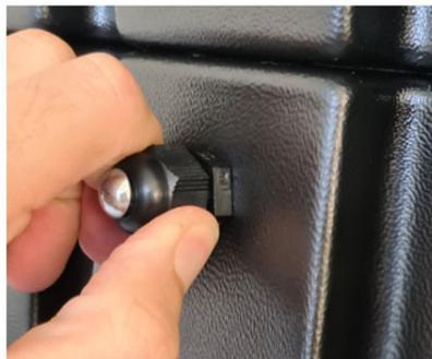
6. Richten Sie das Belüftungssystem mit den drei vorderen Pfeilen nach unten aus und schließen Sie dann das Kabel des Systems an den Andrew+ Pod an.
