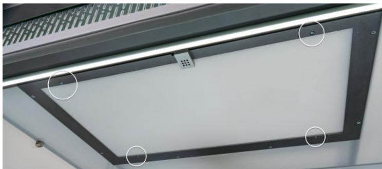
2. Öffnen Sie das Vorfiltermodul und überprüfen Sie, ob der Filter richtig montiert ist.
