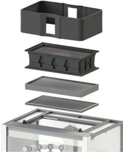
**So installieren Sie den Andrew+ Pod als Abzugsschrank mit Filterung:**
