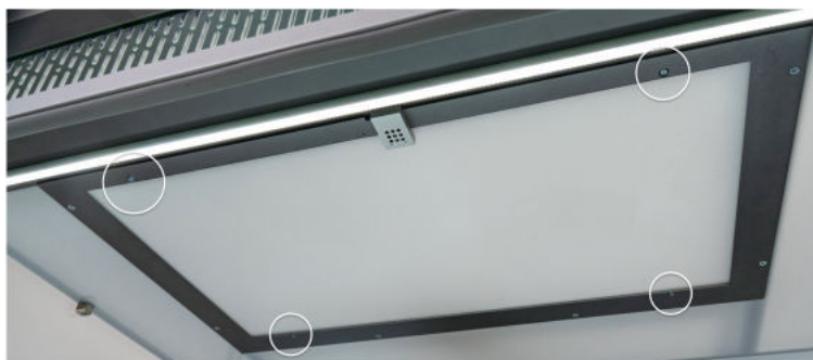
Figura 2–37: Quitar los tornillos de la cubierta antipolvo
