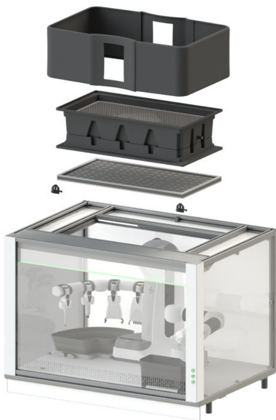
Figura 2–29: Configuración del módulo de ventilación sin filtración
