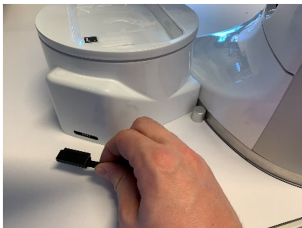
Figura 2–65: Acoplar el conector magnético al ARS
