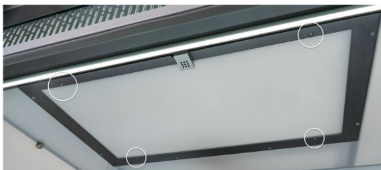
Figura 2–30: Quitar los tornillos de la cubierta antipolvo
