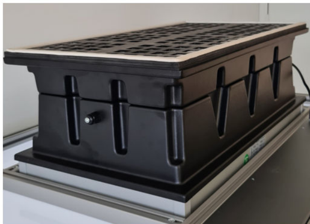
Figura 2–55: Prefiltro sobre el filtro HEPA
