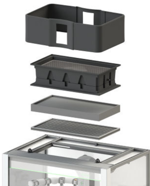
Figura 2–40: Configuración del armario de filtración de gases
