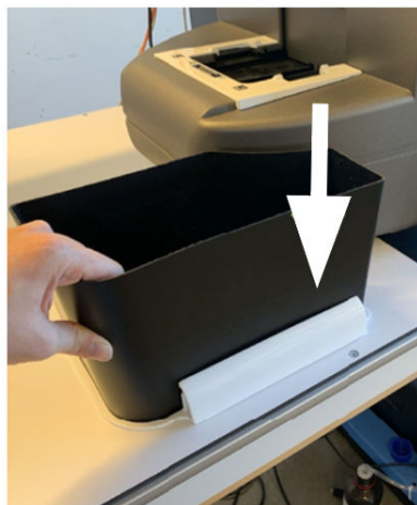
Figura 2–21: Insertar el recipiente extraíble de desecho de puntas
