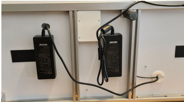
Figura 2–12: Instalar la fuente de alimentación de Andrew+
