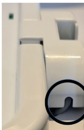
Figura 2–61: Posición correcta del conector del enlace de desechos de la unidad Domino
