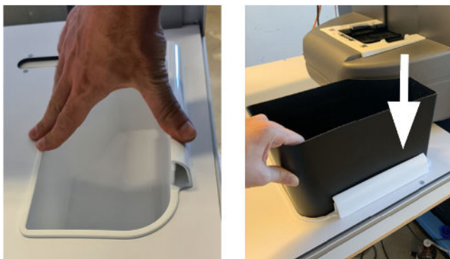
Figura 2–20: Instalar el soporte del recipiente de desechos
