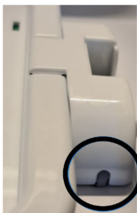
Figura 2–61: Posición correcta del conector del enlace de desechos de la unidad Domino
