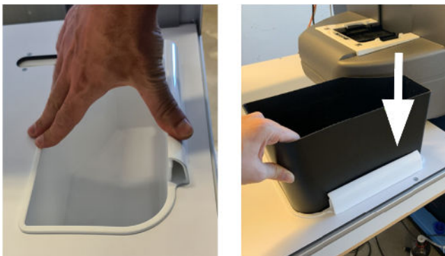
Figure 2–20 : Installation du support du récupérateur de déchets
