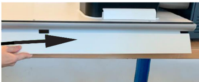
Figure 2–23 : Sécurisation du panneau avant
