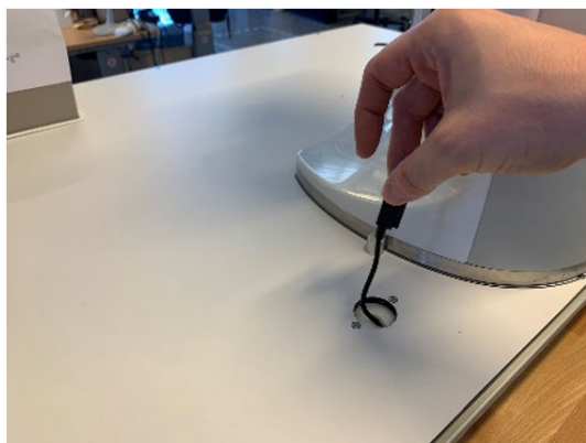
Figure 2–63 : Tirage du câble du système ARS
