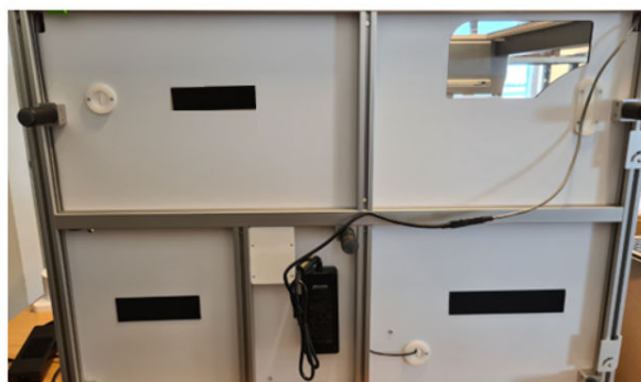
Figure 2–11 : Installation de l'alimentation électrique externe
