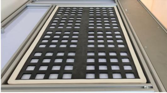
5. Posizionare il filtro con la guarnizione in schiuma rivolta verso l'alto, assicurandosi che sia fissato correttamente su tutti i lati.
