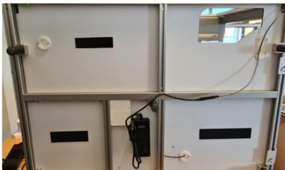
10. Installare l'alimentatore di Andrew+ (posizione 1) e far passare il cavo attraverso la porta di passaggio del cavo di alimentazione di Andrew+ (posizione 5).
