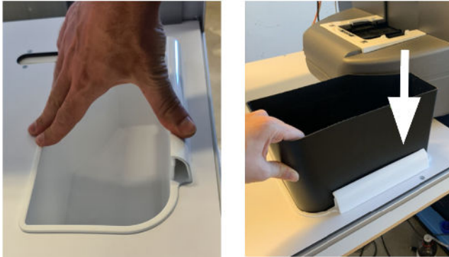
그림 2-20: 폐기통 홀더 설치
