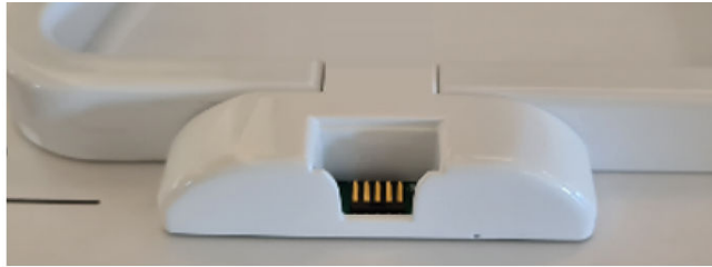
그림 2-61: Waste Link Domino 커넥터의 올바른 위치
