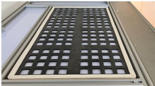
5. Coloque o filtro com a gaxeta de espuma voltada para cima, garantindo que ela esteja presa corretamente em todos os lados.
