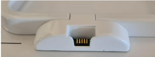
**Figura 2–61: Posição correta do conector do Domino da conexão de descarte**
