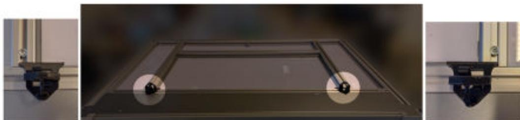
8. Coloque a tampa de ventilação em torno do sistema de ventilação para fechá-la.
