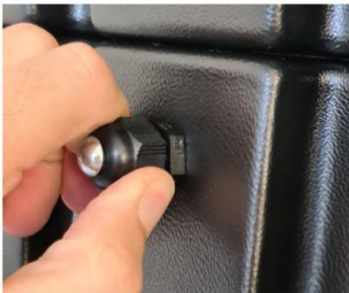
6. Coloque o sistema de ventilação com as três setas frontais voltadas para cima e conecte seu cabo ao Andrew+ Pod.
