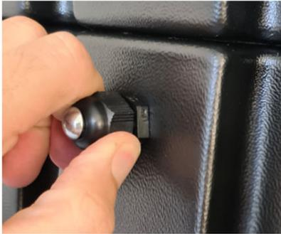
6. Coloque o sistema de ventilação com as três setas frontais voltadas para baixo e conecte seu cabo ao Andrew+ Pod.
