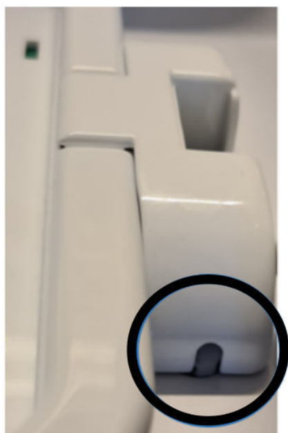
图 2-61： 废弃物链接 Domino 连接器的正确位置
