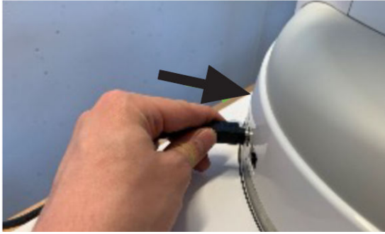
图 2-62： 将电源线连接到主电源
