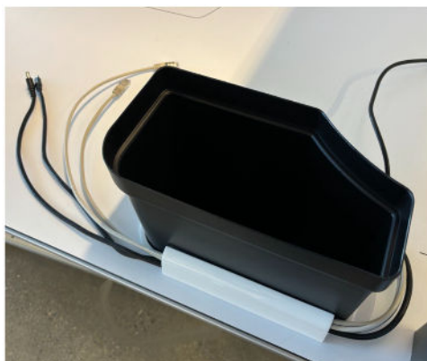
图 2-22： 布设电源线和以太网线缆
