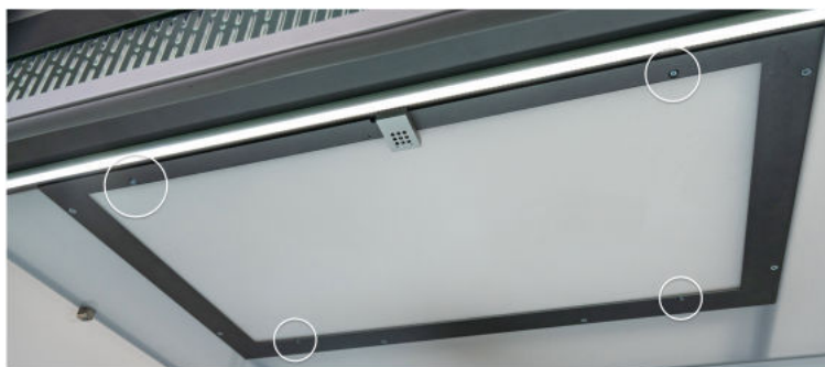
图 2-50：拆下防尘盖螺钉
