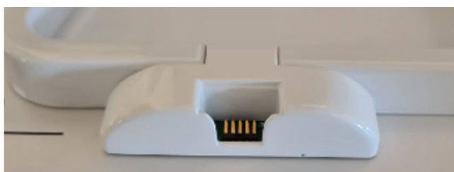
图 2-60： 废弃物链接 Domino 连接器
