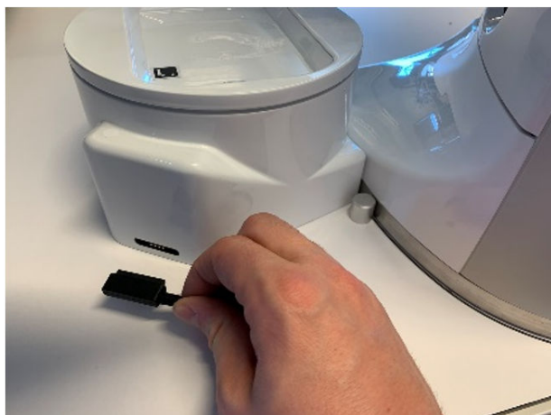
图 2-65: 将磁性连接器连接到 ARS 上
