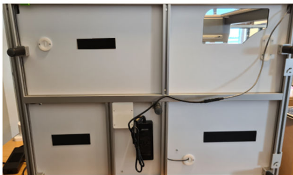
图 2-11： 安装外部电源
