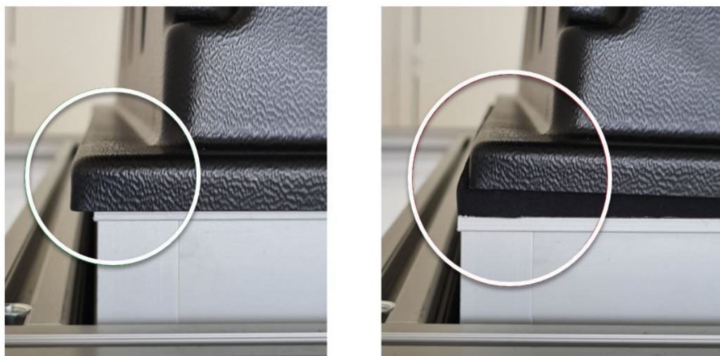
图 2-54： 对齐通风系统和 HEPA 过滤器
