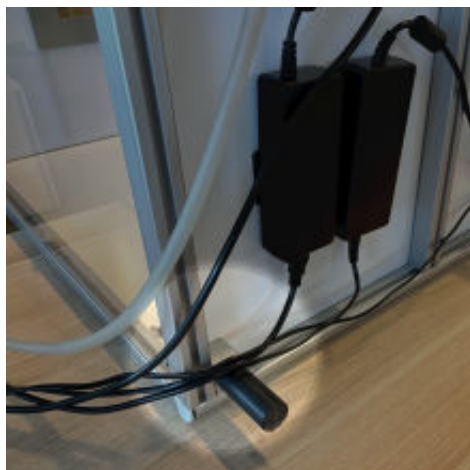
图 2-17： 旋转 Pod 时理好线缆
