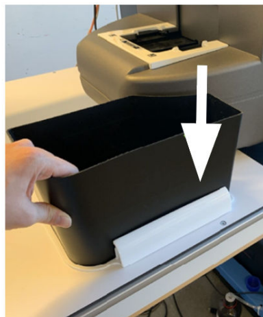
图 2-21： 插入可拆卸的废枪头容器
