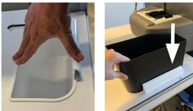
图 2-20： 安装废弃物容器座
