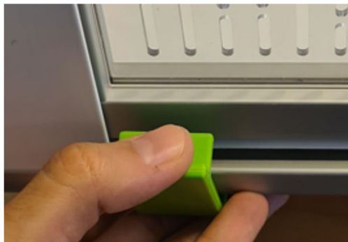
图 2-19： 拆卸隔离窗固定夹
